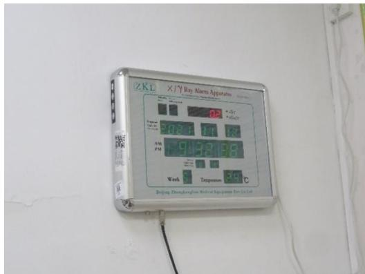
图 3-22 在线辐射监测仪控制室显示单元
