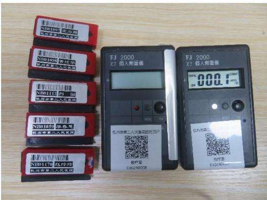
图 3-23 个人剂量计及个人剂量报警仪
