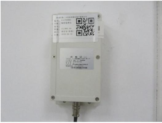
图 3-25 在线辐射监测仪机房内探头
